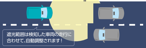
※自車速度約15km/h以上（一部の車種では自車速度約30km/h以上）で動作
