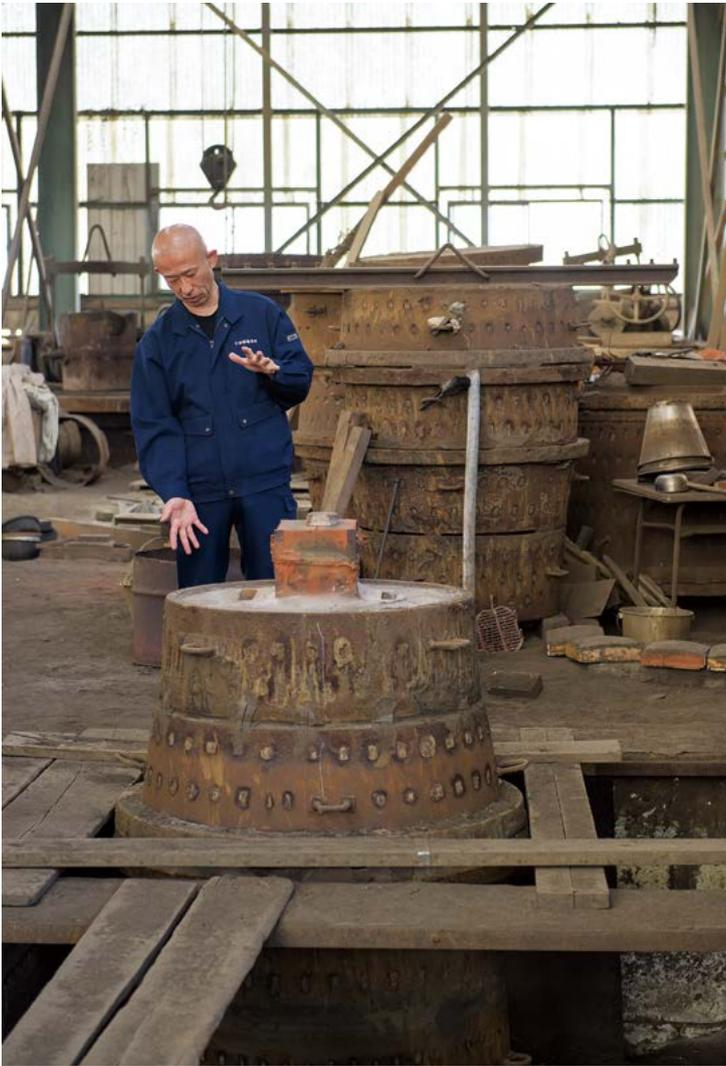
型づくりは作業所内に掘られた穴を利用して行われる。小田部さんの前にある素焼きの型の内部に、天女の絵や文字を凹型にした鋳型などをはめ込み、間を砂と粘土で滑らかに埋めて梵鐘の外型の模様がつくられる。鋳込み後は型を壊して梵鐘を取り出すため、型は残らず、砂として再生される。
