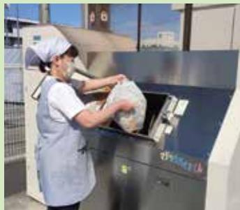
本社社員食堂から出た生ごみは生ごみ処理機で処理することで大幅なごみ減量化、ごみ処理費用の削減になります。年間約2,400kg排出していた生ごみは80%以上が水と炭酸ガスに分解され、発酵分解した残りは有機肥料の原料になります。
