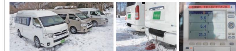
3車種の時間経過による室内温度の比較 (19:00 エンジンとヒーターをスタート、22:00 エンジン停)
