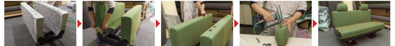
クッションだけの裸の状態からメーカーから納品されるキャンピングカーシート。 たるみやシワがないよう織られたぴったりサイズのカバーをはめていく。 ヘッドレスト部分のフレームを入れていきシートをしっかりと固定する。 もちろんヘッドレストにもシート同様に、熟練の技でカバーをはめていく。 トイファクトリー品質の張りのある美しいセカンドシートが完成します。
