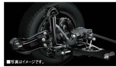
■写真はイメージです。 ダブルウィッシュボーンリヤサスペンション
